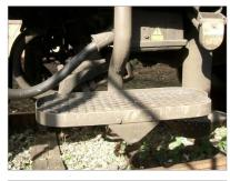
15. Die Tritte sind jetzt fertig zur Montage am Wagen. Der Tritthalter muss, je nach Einbausituation, oben noch etwas gekürzt werden. Der Soll-Abstand von der Oberkante des Trittbretts zum Wagenboden beträgt 3,6 mm.
